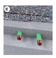
In molti casi, è preferibile utilizzare due strati di spessore minore (3+3 mm, 4+4 mm): in questo caso si raccomanda di stendere il secondo strato avendo cura di coprire la giunzione dei tappeti del primo strato.
