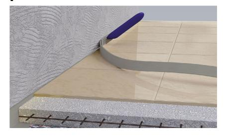
Solo dopo la posa della pavimentazione e facendo attenzione che il pavimento batta sulle strisce perimetrali e non contro la parete, rifilare il materiale in eccesso delle strisce per tutto il perimetro della stanza.
