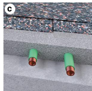
In molti casi, è preferibile utilizzare due strati di spessore minore (3+3 mm, 4+4 mm): in questo caso **si raccomanda di stendere il secondo strato avendo cura di coprire la giunzione dei tappeti del primo strato.**
