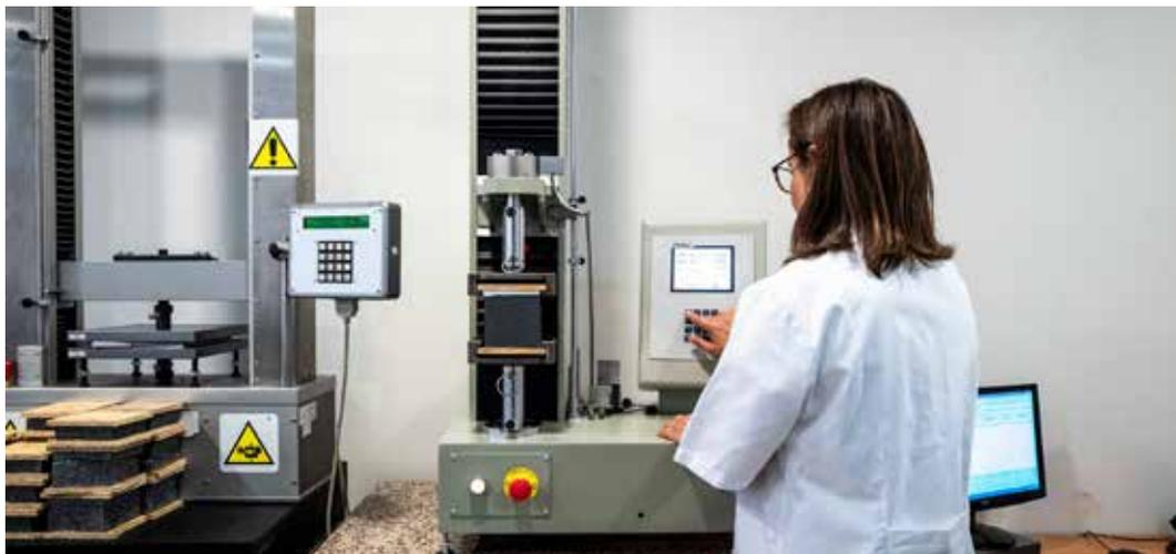
*Il nostro laboratorio per il controllo della qualità: test per resistenza a trazione e compressione*
