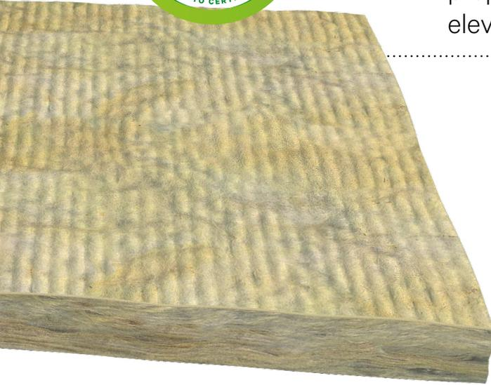
Isolanti termoacustici biosolubili, traspiranti, idrorepellenti, resistenti all'acqua e al fuoco, ottenuti dalla fusione di rocce vulcaniche e calcaree (basalto, dolomite, bauxite).
