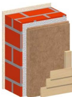
*Costruzione retroventilata in muratura con GUTEX Multitherm<sup>®</sup> dietro alla facciata in legno*
