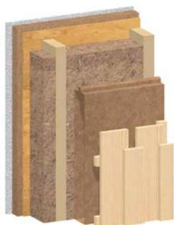
*Facciata ventilata su intelaiatura in legno con isolamento di intercapedini GUTEX Thermofibre<sup>®</sup>/ GUTEX Thermoflex<sup>®</sup> e GUTEX Multitherm<sup>®</sup> dietro alla facciata in legno*
